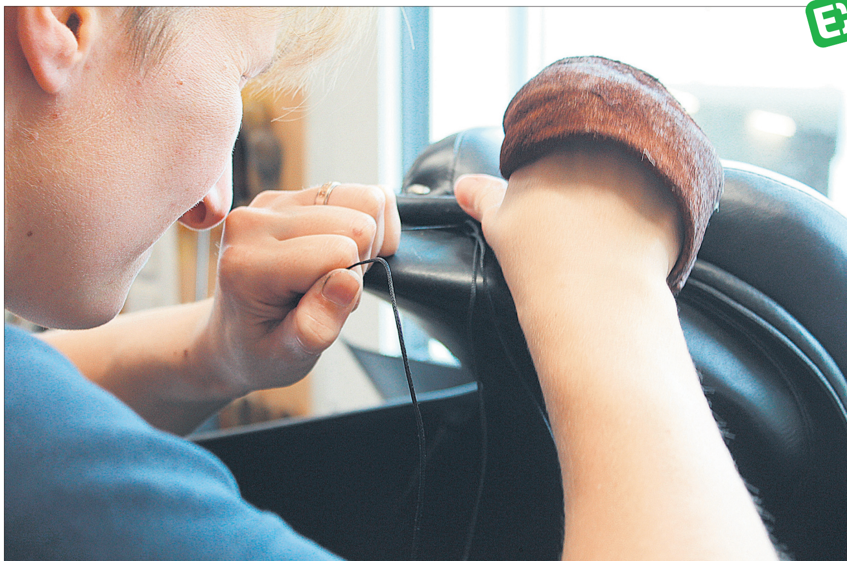
Julia Rösli näht die fertigen Sattelpissen am hinteren Teil des Sattels an. In ihrer rechten Hand trägt sie dafür einen Lederschutz.
