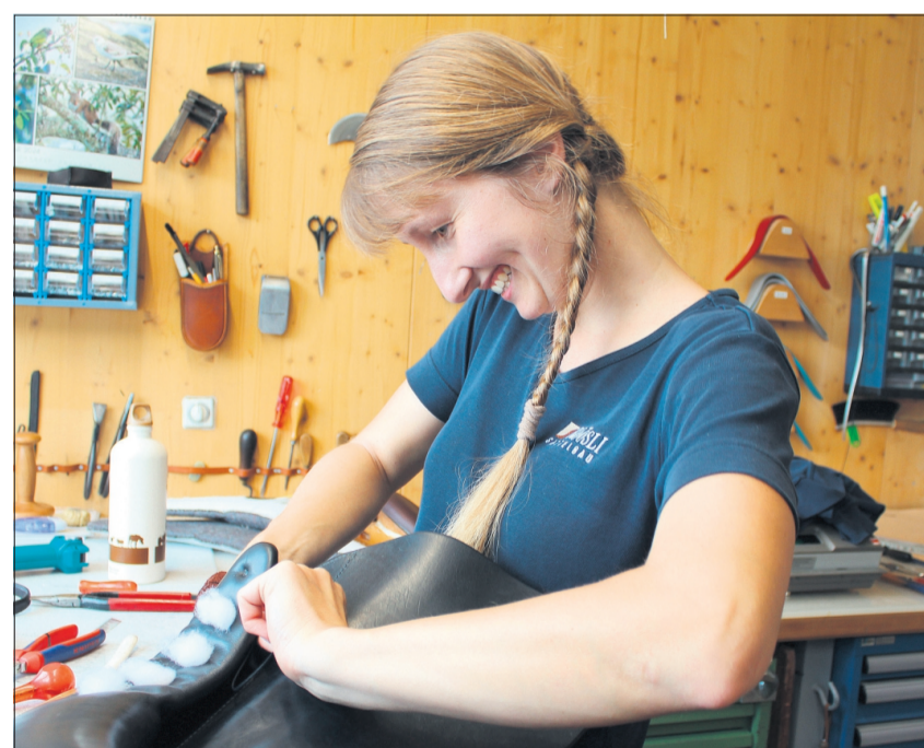
Die Sattelpissen werden pro Sattelblatt mit jeweils fünf Abheftern angenäht.
