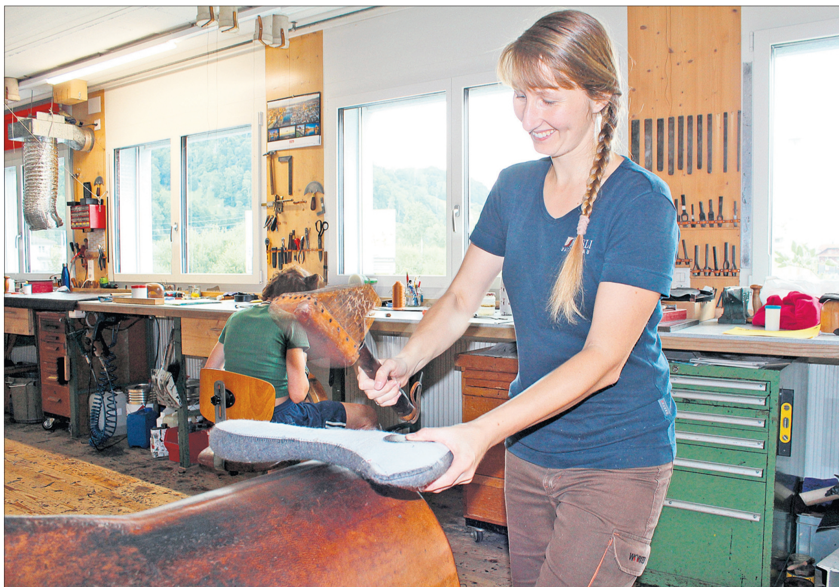
Die Fachfrau Leder und Textil Julia Rösli klopft die Filzkissen für die Sattelskissen gut durch, damit die Schurwolle im Innern gut durchmischt wird.
